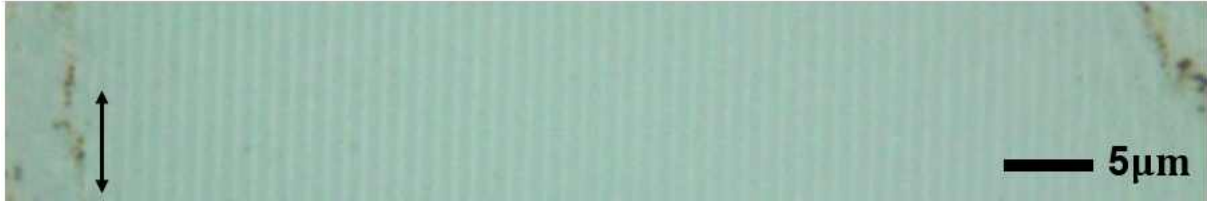
Abbildung 22: type- c LIPSS auf Ti 20nm induziert durch \lambda = 532\text{nm} unter \Theta = 60^\circ
